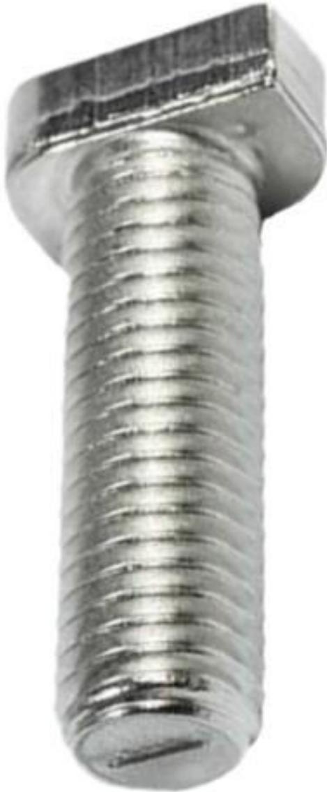
Die Hammerkopfschraube M10 x 32,5mm (Kopfmaß 17x10mm) ist vielseitig einsetzbar. Sie wird auch als Alternative zur Sechskantschraube M10 x 25mm DIN 933 verwendet, um eine Solar-Montage-Schienen-Unterkonstruktion einer Photovoltaik-Anlage auf Flach- und Schrägdächern zu befestigen.
