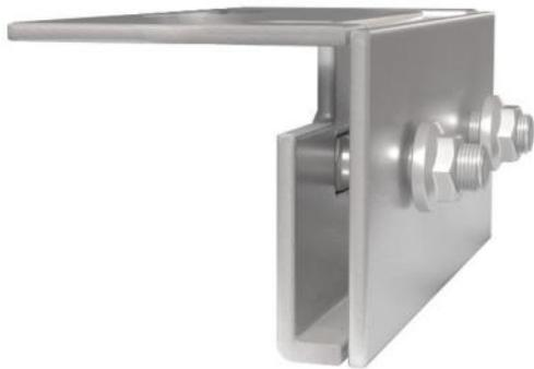
Die Befestigungsklemme mit zwei Befestigungsschrauben ist für Dächer mit Stehfalzdeckung aus Zink, Aluminium und Stahl geeignet. Der Klemmbereich beträgt 3,5mm und ist für die meisten Dächer geeignet. Die Lieferung der Klemme erfolgt vormontiert, sie kann ohne weitere Vorarbeiten am Dach befestigt werden.
